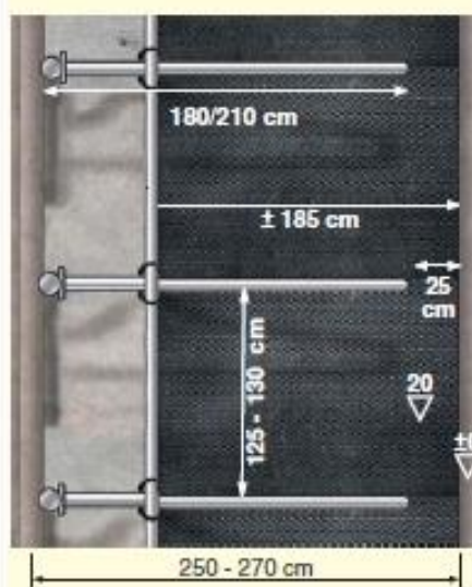
Dimensiuni de asamblare a cusetei Comfort pentru animale grele (Nu sunt orientari obligatorii)
